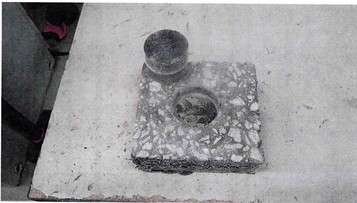
Рисунок 2 – Образец 148/1 МДС № 2, испытанный по ГОСТ Р 59180-2021. Определение прочности сцепления на отрыв при температуре -40 °С
