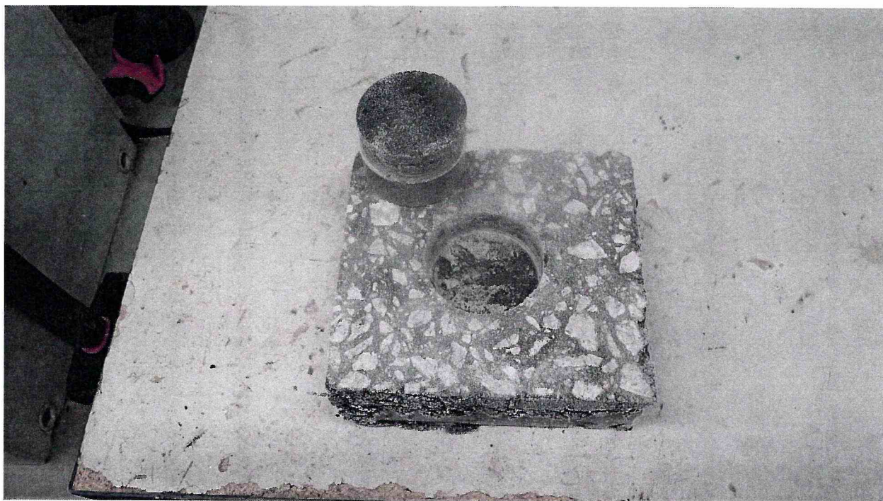
Рисунок 5 – Образец 148/1 МДС № 5, испытанный по ГОСТ Р 59180-2021. Определение прочности сцепления на отрыв при температуре -40\text{ }^{\circ}\text{C}
