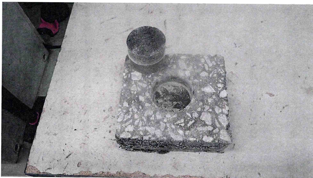
Рисунок 4 – Образец 148/1 МДС № 4, испытанный по ГОСТ Р 59180-2021. Определение прочности сцепления на отрыв при температуре -40\text{ }^{\circ}\text{C}
