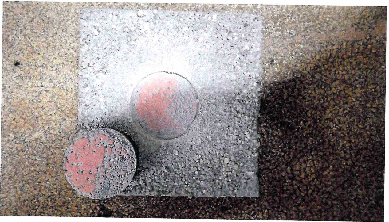
Рисунок 3 – Образец 203/3 МДС № 3, испытанный по ГОСТ Р 59180-2021. Определение прочности сцепления на отрыв при температуре
