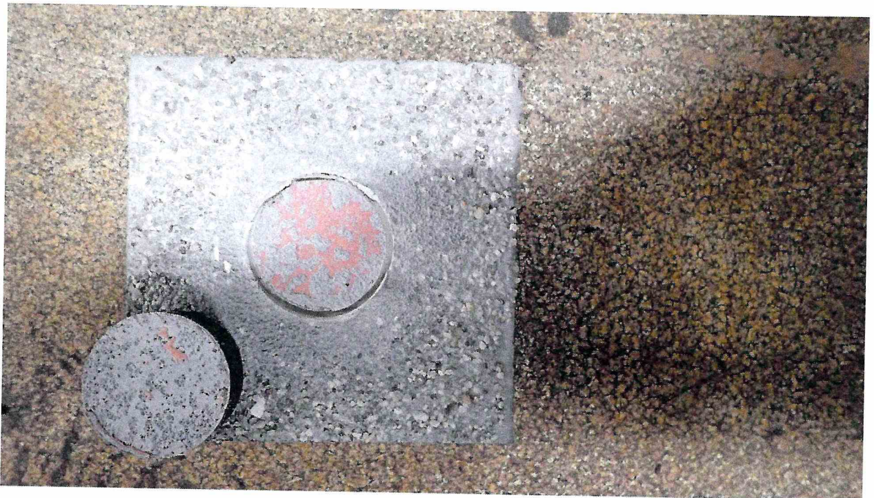
Рисунок 4 – Образец 203/3 МДС № 4, испытанный по ГОСТ Р 59180-2021. Определение прочности сцепления на отрыв при температуре 23 °С
