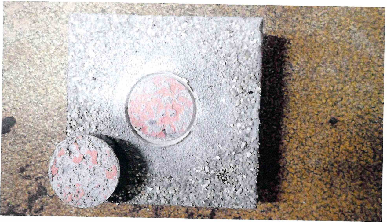
Рисунок 5 – Образец 203/3 МДС № 5, испытанный по ГОСТ Р 59180-2021. Определение прочности сцепления на отрыв при температуре 23 °С
