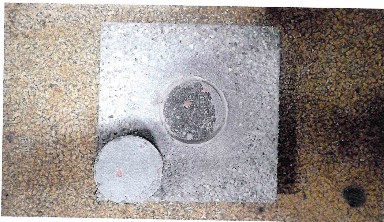
Рисунок 2 – Образец 203/3 МДС № 2, испытанный по ГОСТ Р 59180-2021. Определение прочности сцепления на отрыв при температуре 23 °С
