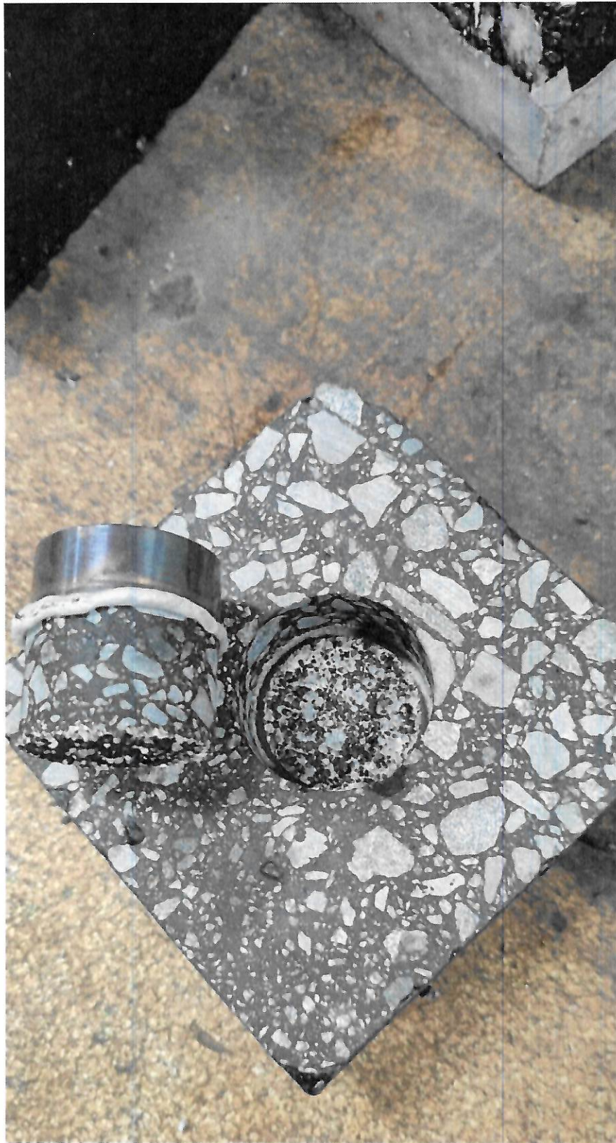
Рисунок 4 – Образец № 4 +23 МДС, испытанный по ГОСТ Р 55402-2013, ГОСТ Р 59180-2021, определение прочности сцепления на отрыв при температуре +23°C
