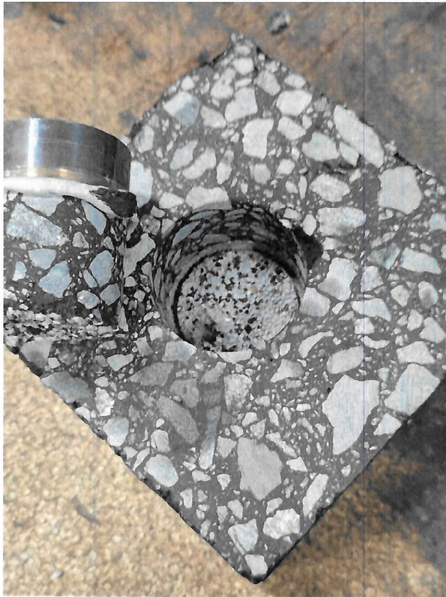
Рисунок 5 – Образец № 5 +23 МДС, испытанный по ГОСТ Р 55402-2013, ГОСТ Р 59180-2021, определение прочности сцепления на отрыв при температуре +23°C
