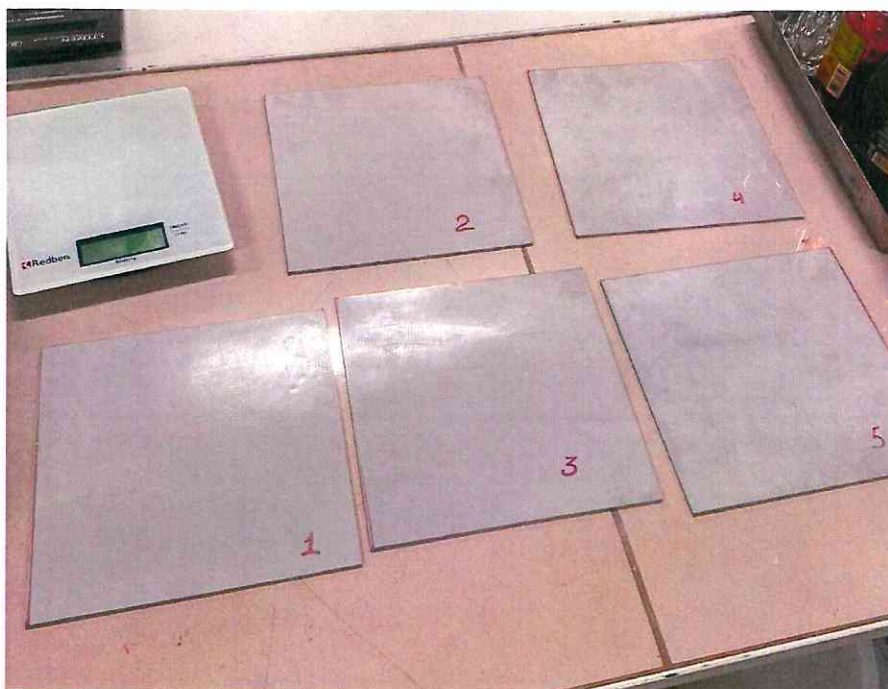
Рисунок А.1 – Образцы мембраны «Рабберфлекс-55» перед проведением испытаний на водопоглощение
