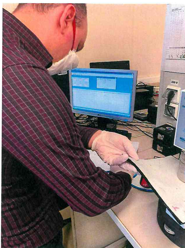
Рисунок А.6 – Измерение значения твердости по Шору (А) образцов мембраны «Рабберфлекс-55» перед погружением в воду
