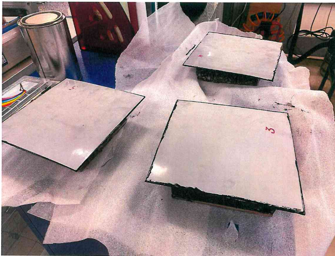
Рисунок А.3 – Обработка боковых граней образцов № 3, № 4, № 5 термостойкой и влагостойкой эпоксидной смолой «ТИАЛ»
