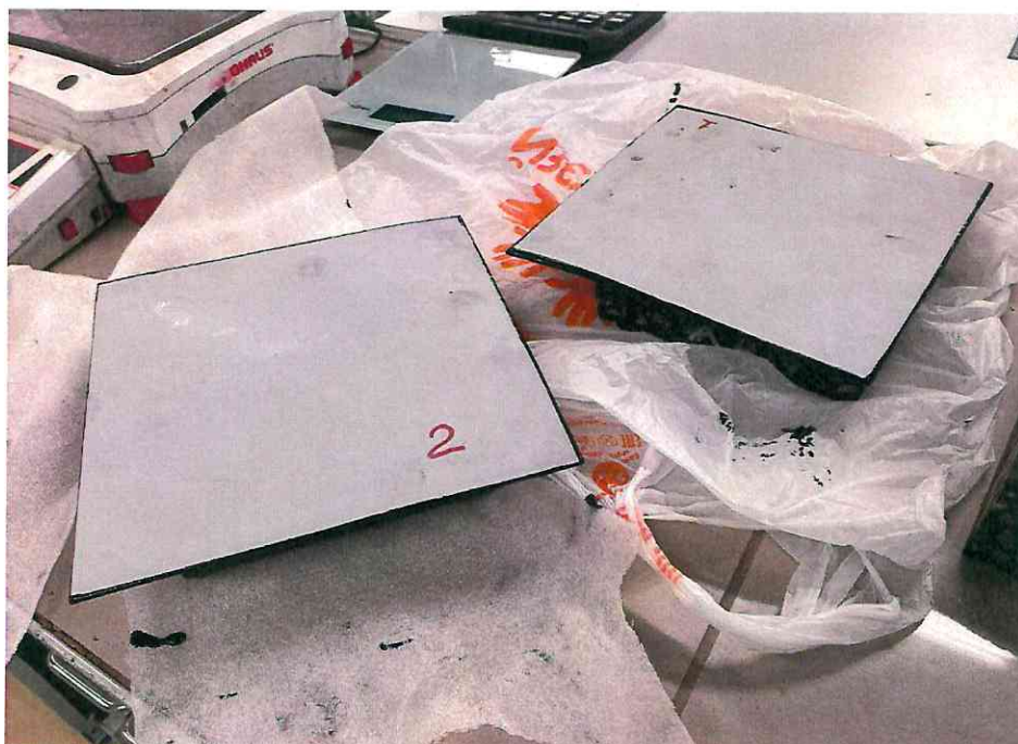
Рисунок А.2 – Обработка боковых граней образцов № 1, № 2, термостойкой и влагостойкой эпоксидной смолой «ТИАЛ»
