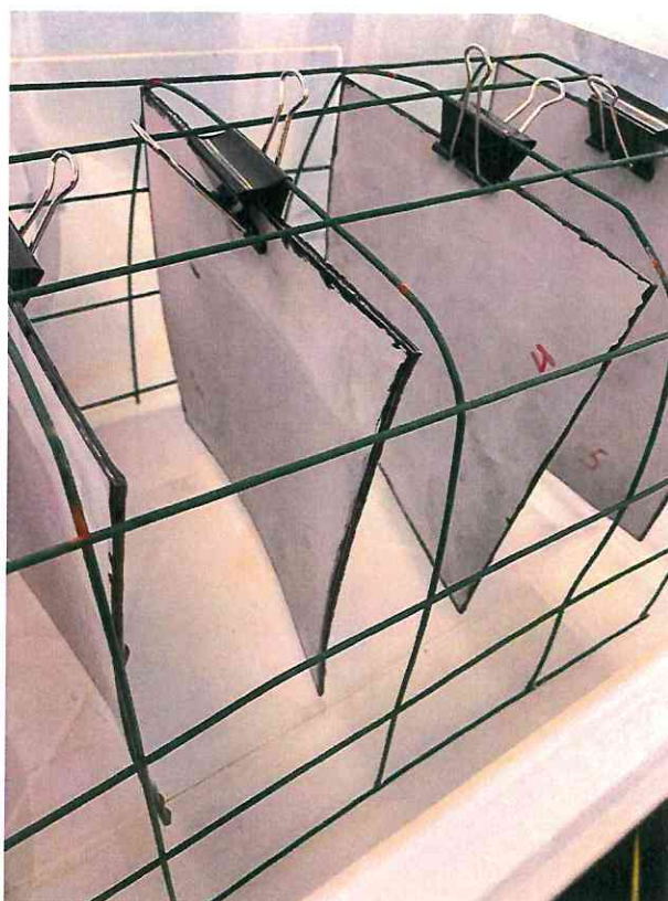
Рисунок А.4 – Образцы мембраны «Рабберфлекс-55» в процессе кондиционирования при температуре 23 °С и относительной влажности воздуха 50 %
