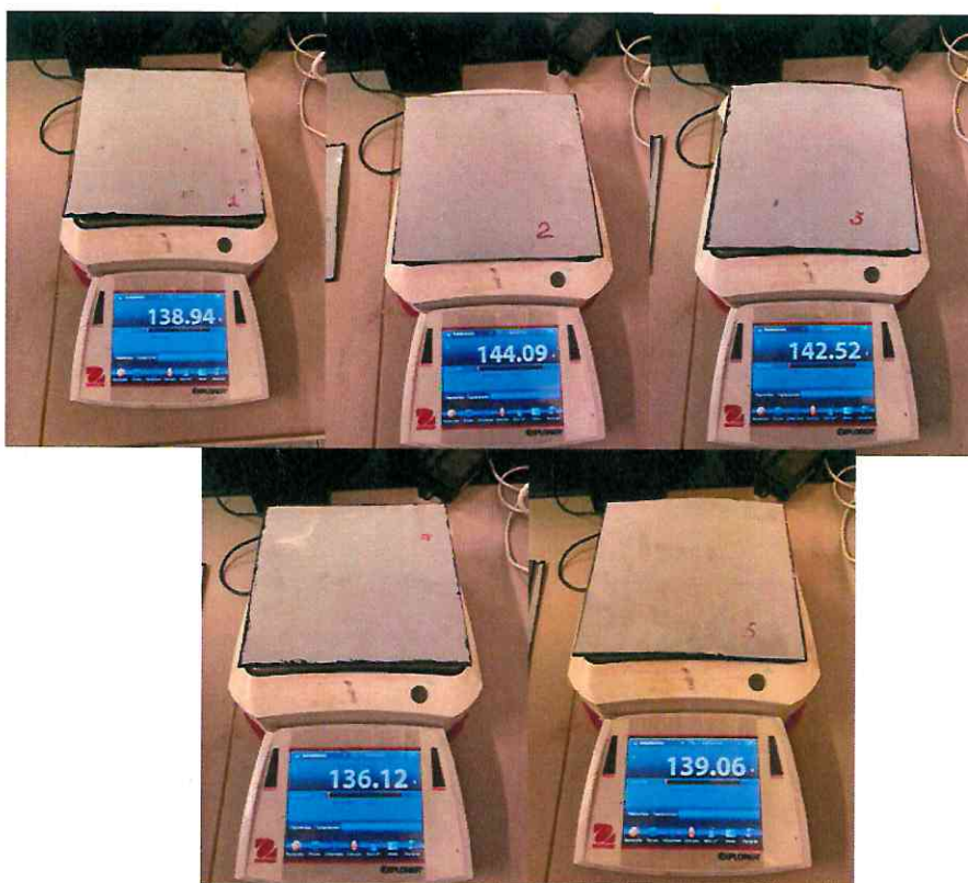
Рисунок А.5 – Контрольное взвешивание образцов мембраны «Рабберфлекс-55» перед погружением в воду
