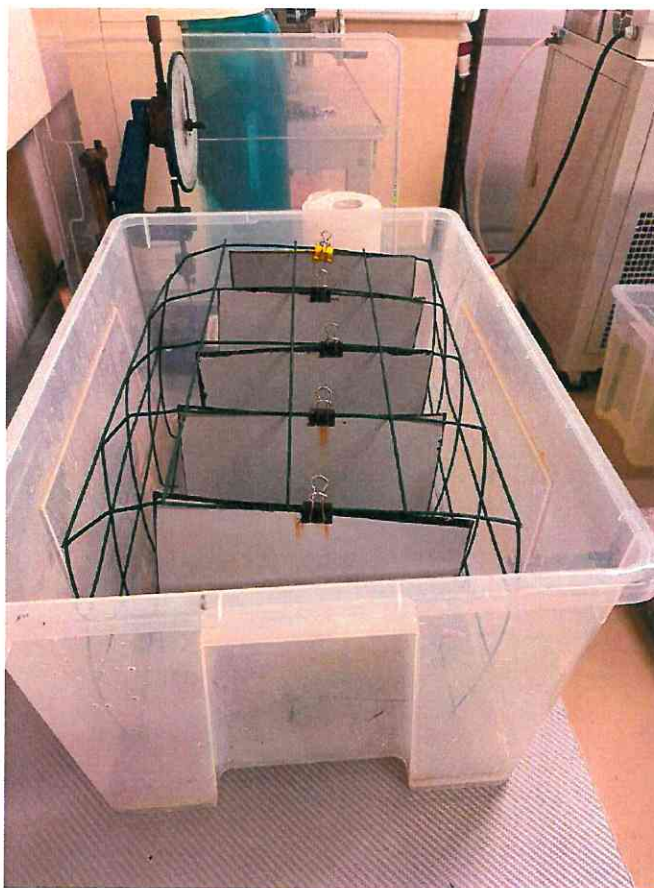
Рисунок А.7 – Кондиционирование образцов после выдержки в воде в течение 5 часов при температуре 23 °С и относительной влажности 50%
