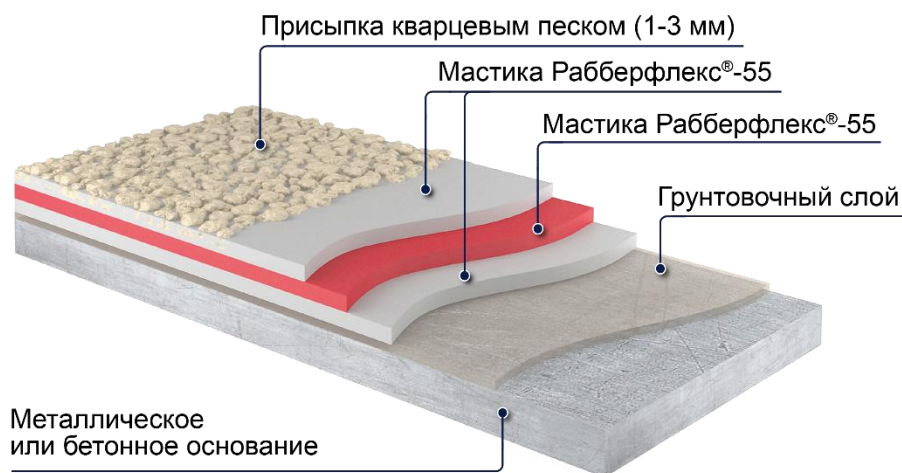
Рисунок 2 - Система гидроизоляции «Рабберфлекс®-55»
