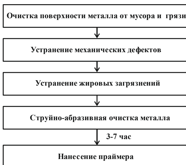
Рисунок 3. Схема технологического процесса подготовки поверхности ортотропной плиты
