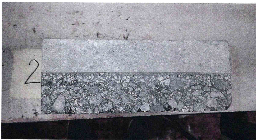
Рисунок 2 – Образец 16/2 МДС № 2, испытанный по ГОСТ Р 59180-2021. Определение прочности сцепления при сдвиге при температуре -40 °С
