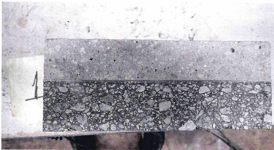
Рисунок 1 – Образец 16/2 МДС № 1, испытанный по ГОСТ Р 59180-2021. Определение прочности сцепления при сдвиге при температуре -40 °С
