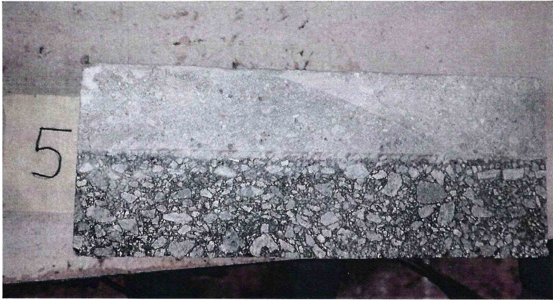
Рисунок 5 – Образец 16/2 МДС № 5, испытанный по ГОСТ Р 59180-2021. Определение прочности сцепления при сдвиге при температуре -40\text{ }^{\circ}\text{C}
