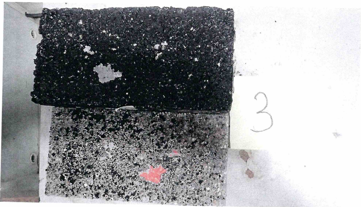
Рисунок 3 – Образец 232/6 МДС № 3, испытанный по ГОСТ Р 59180-2021. Определение прочности сцепления при сдвиге, при температуре 50 °С
