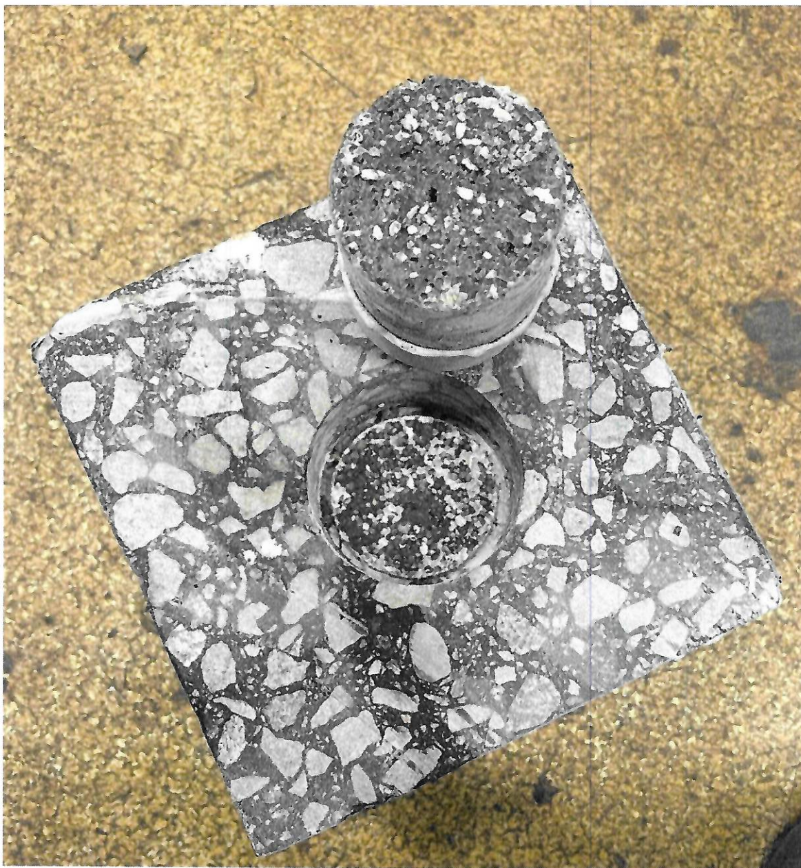
Рисунок 4 – Образец № 4 -40 МДС, испытанный по ГОСТ Р 55402-2013, ГОСТ Р 59180-2021, определение прочности сцепления на отрыв при температуре -40°С
