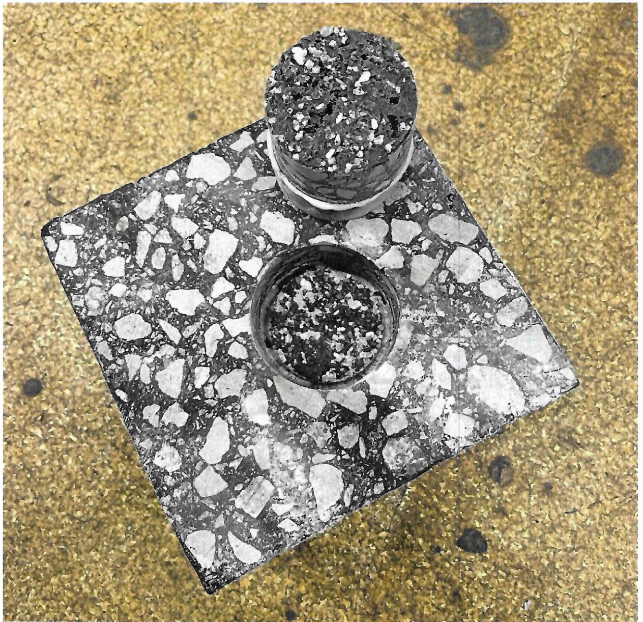
Рисунок 5 – Образец № 5 -40 МДС, испытанный по ГОСТ Р 55402-2013, ГОСТ Р 59180-2021, определение прочности сцепления на отрыв при температуре -40°С
