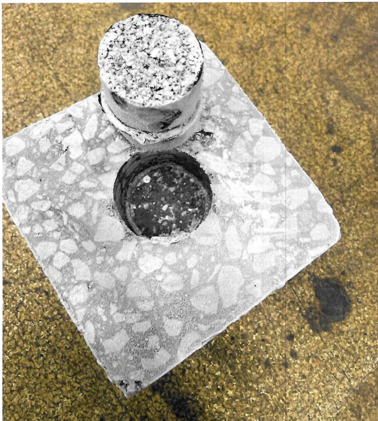
Рисунок 1 – Образец № 1 -40 МДС, испытанный по ГОСТ Р 55402-2013, ГОСТ Р 59180-2021, определение прочности сцепления на отрыв при температуре -40^{\circ}\text{C}
