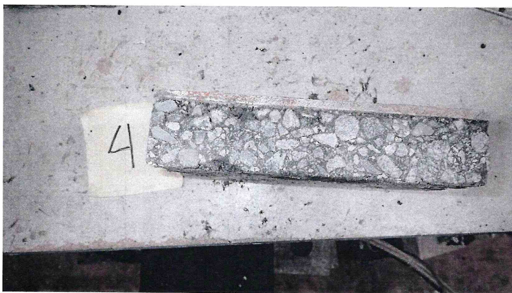
Рисунок 4 – Образец 16/7 МДС № 4, испытанный по ГОСТ Р 59180-2021. Определение прочности сцепления при сдвиге при температуре -40\text{ }^{\circ}\text{C}
