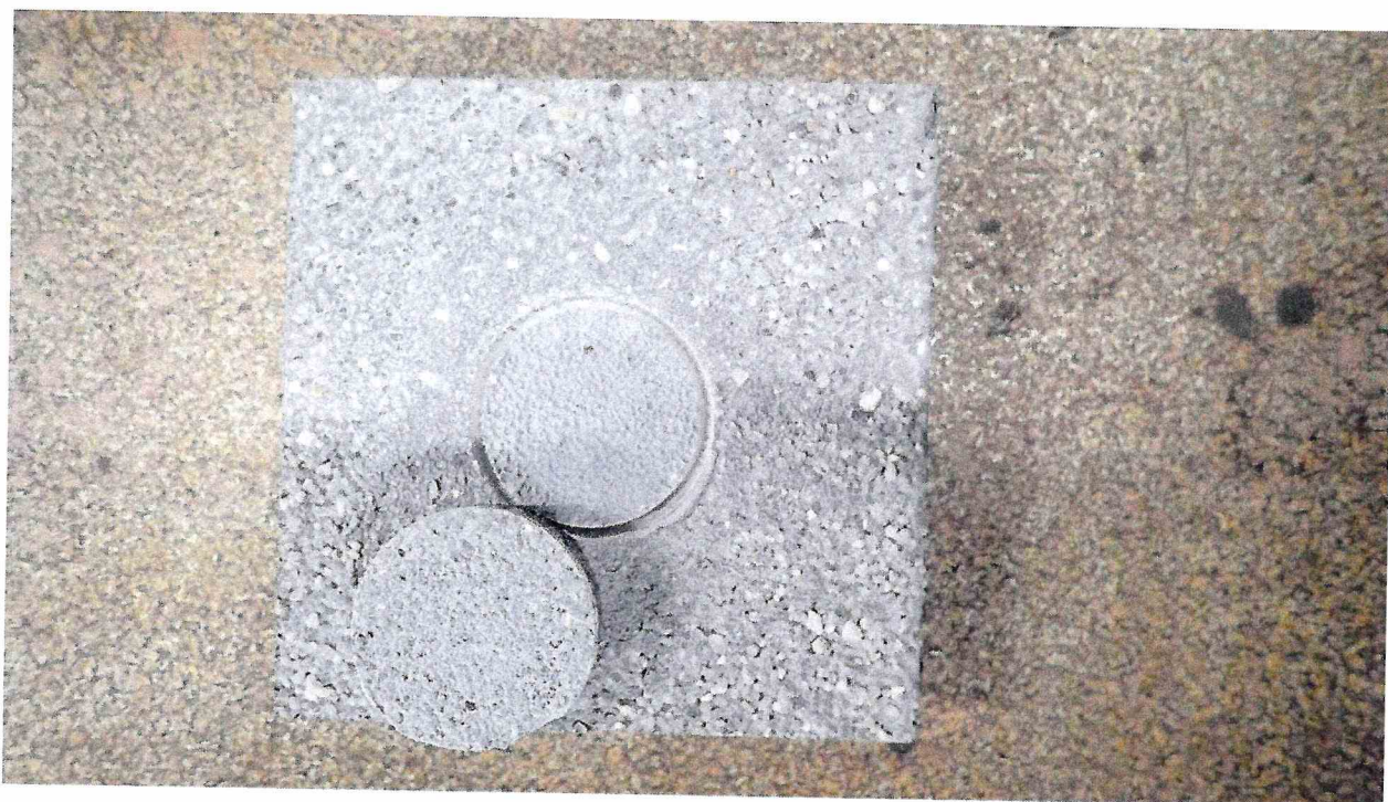
Рисунок 4 – Образец 203/1 МДС № 4, испытанный по ГОСТ Р 59180-2021. Определение прочности сцепления на отрыв при температуре 23 °С
