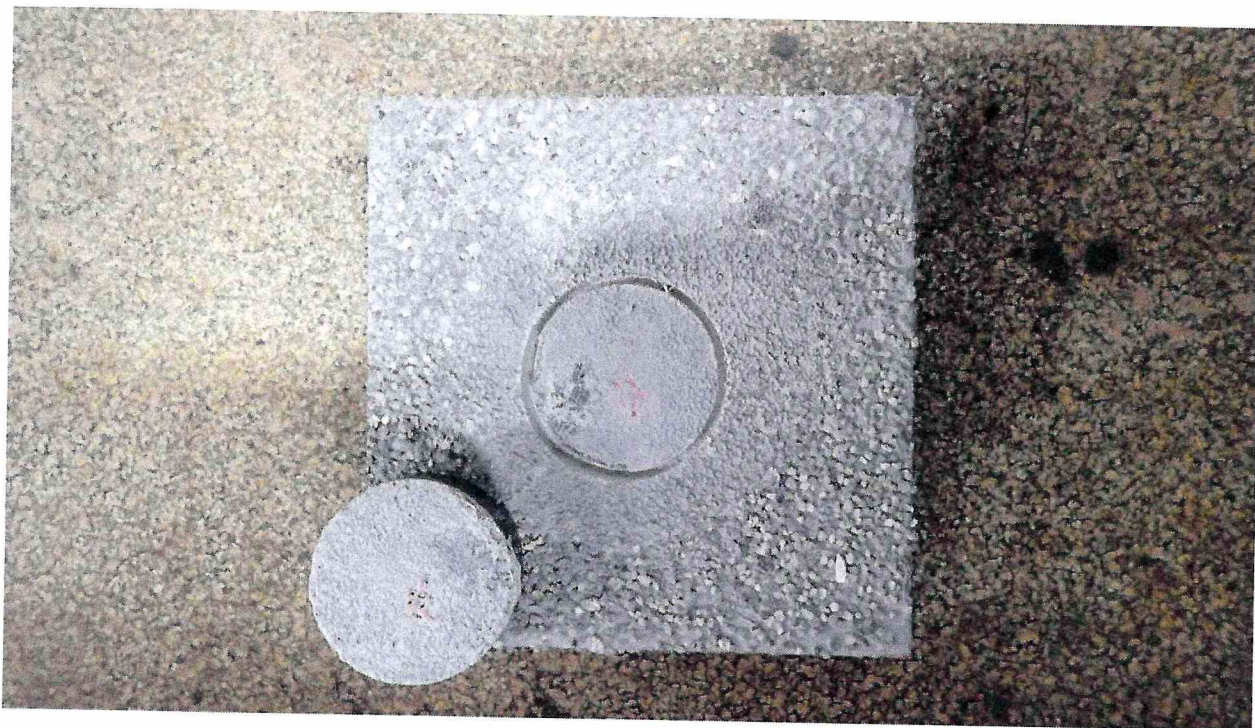
Рисунок 5 – Образец 203/1 МДС № 5, испытанный по ГОСТ Р 59180-2021. Определение прочности сцепления на отрыв при температуре 23 °С
