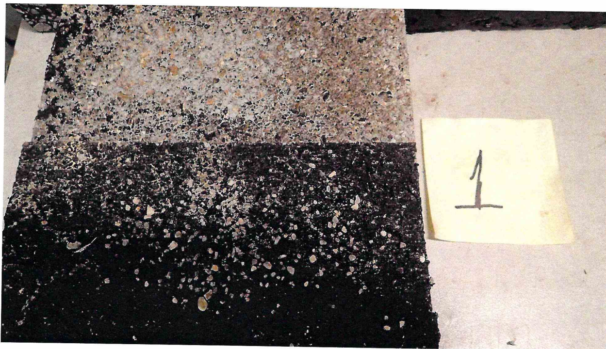
Рисунок 1 – Образец 232/2 МДС № 1, испытанный по ГОСТ Р 59180-2021. Определение прочности сцепления при сдвиге, при температуре 50 °С
