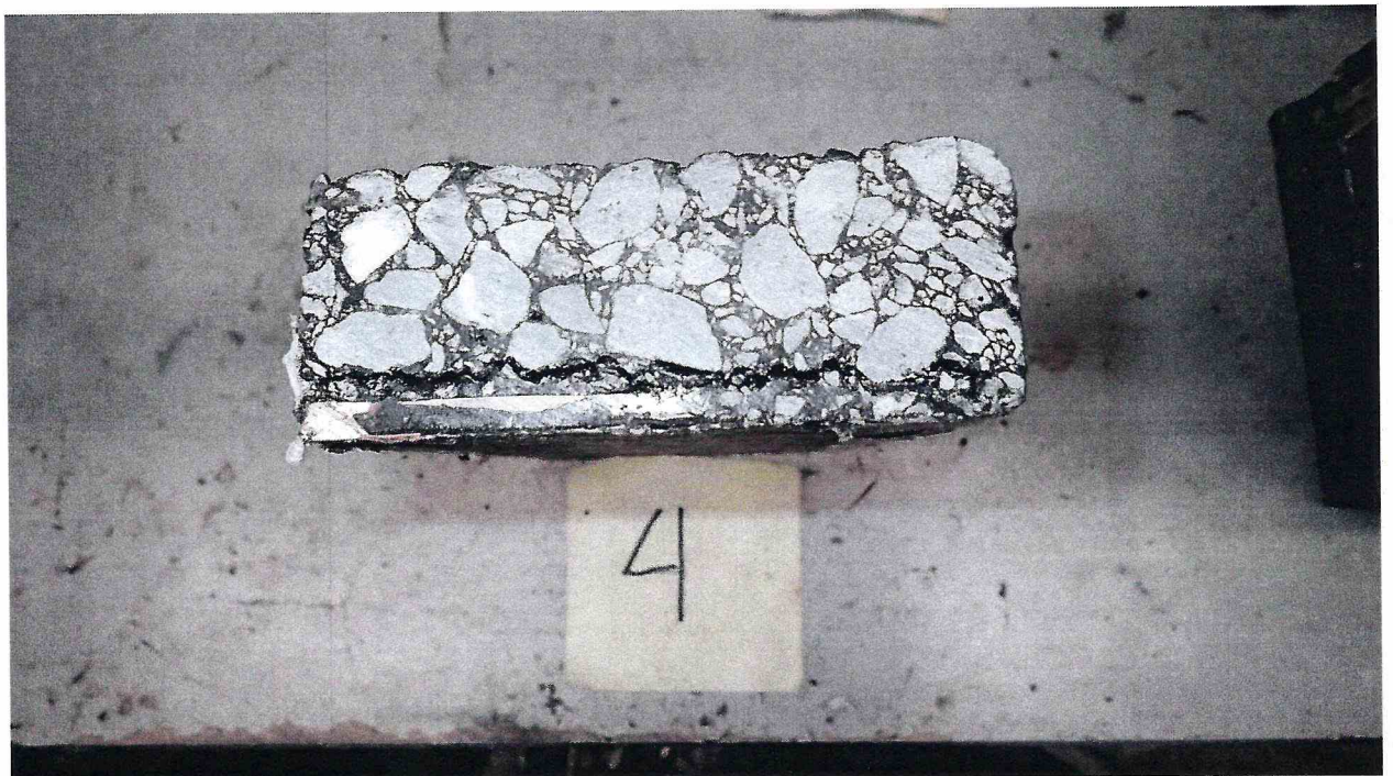
Рисунок 4 – Образец 3/1 МДС № 4, испытанный по ГОСТ Р 59180-2021. Определение прочности сцепления при сдвиге, при температуре 23 °С
