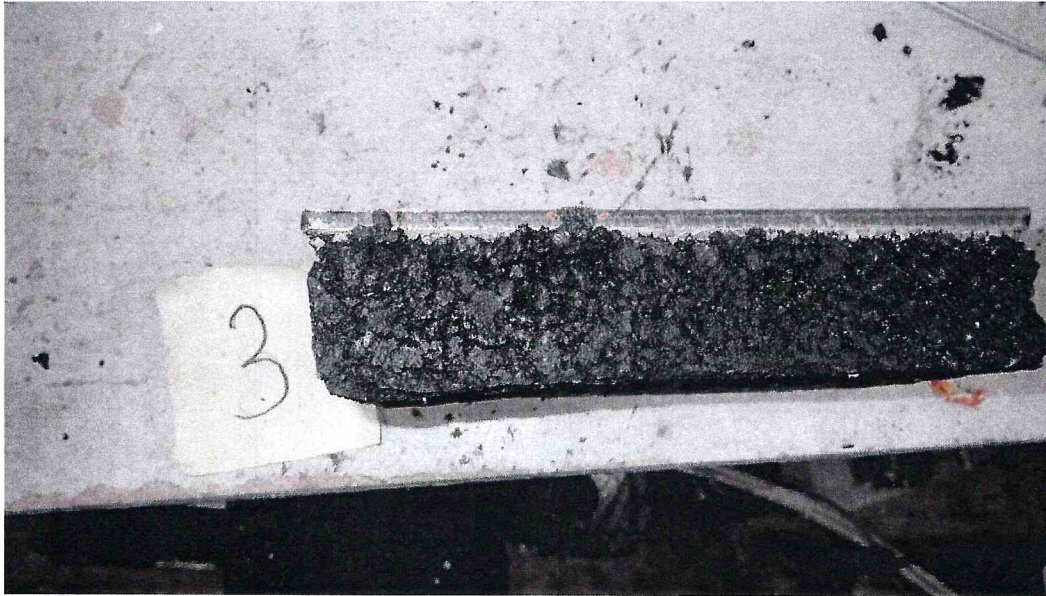
Рисунок 3 – Образец 16/8 МДС № 3, испытанный по ГОСТ Р 59180-2021. Определение прочности сцепления при сдвиге при температуре 50 °С
