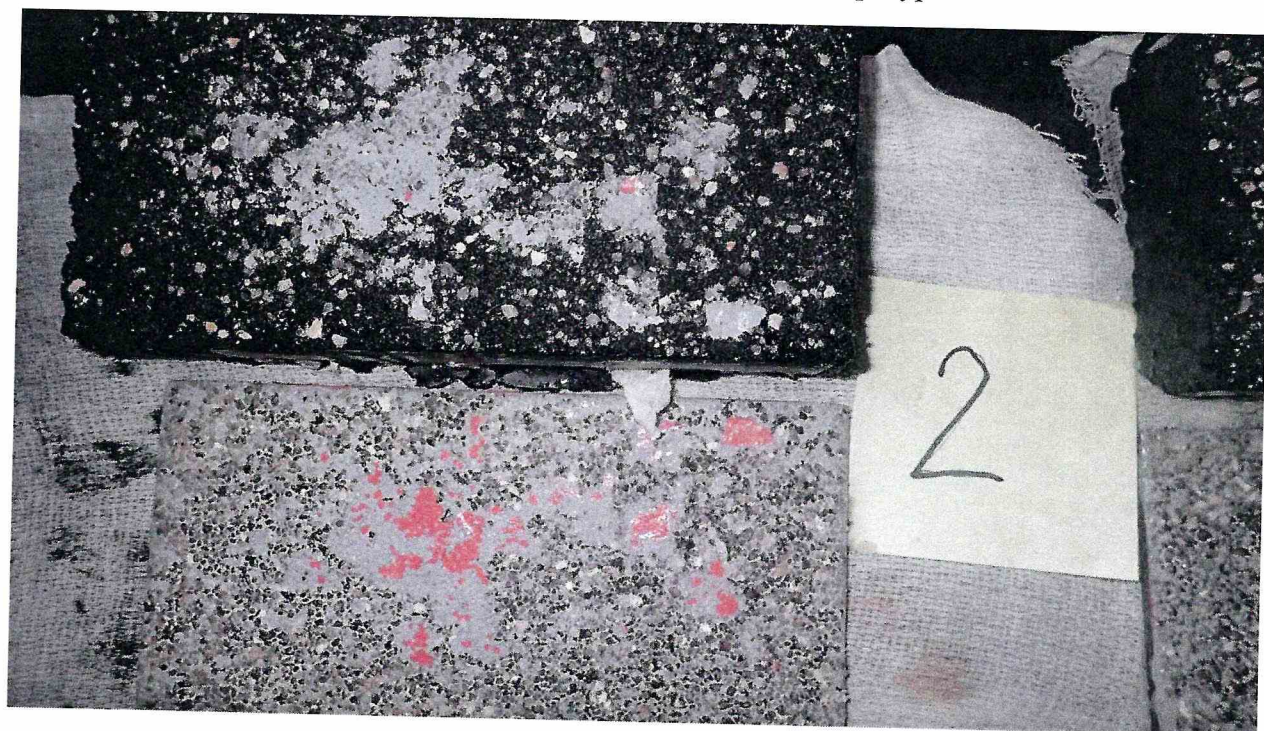
Рисунок 2 – Образец 210/5 МДС № 2, испытанный по ГОСТ Р 59180-2021. Определение прочности сцепления при сдвиге, при температуре -40 °С
