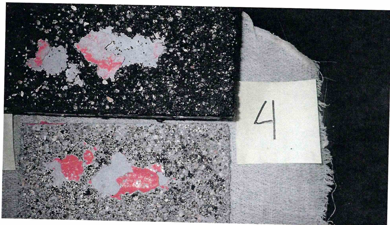
Рисунок 4 – Образец 210/5 МДС № 4, испытанный по ГОСТ Р 59180-2021. Определение прочности сцепления при сдвиге, при температуре -40\text{ }^{\circ}\text{C}
