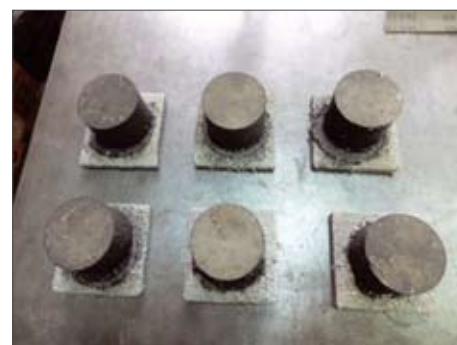
Рис. 3. Образцы с гидроизоляцией «Рабберфлекс®-55» и уплотняемым асфальтобетоном
